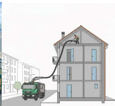
Svuotamento di volte e intercapedini in ambito restauro
